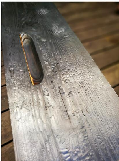
noire brillante. Pour les surfaces du bois près des arêtes et afin d'éviter que ces dernières ne se consomment trop, brûler ces surfaces en dirigeant la flamme de l'intérieur vers l'extérieur de la planche plutôt que d'attaquer les arêtes de front. Pour arrêter le feu le cas échéant, étouffer la flamme par le chiffon sec.
